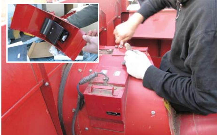
Рис. 1. Установка датчика потока зерна в верхнюю часть зернового элеватора комбайна «Кейс»
