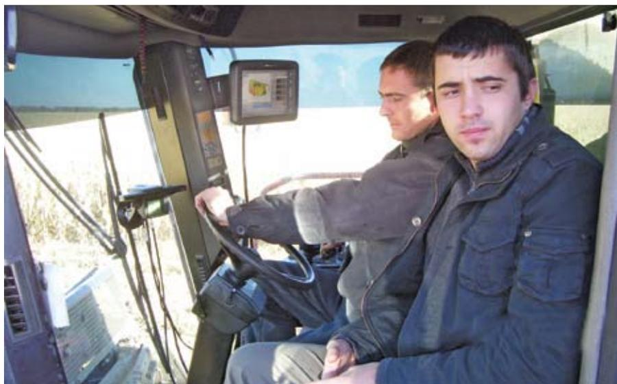
урожайности не изменяется. Исходя из данных от датчиков, запись информации включается и выключается автоматически (подъем и опускание жатки), то есть учет поступающего в бункер зерна и координаты нахождения комбайна на поле будут запоминаться бортовым компьютером только при опущенной жатке.
