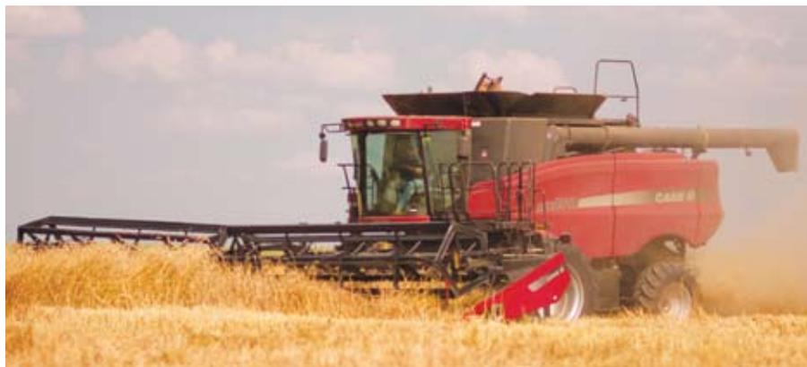
При прямом посеве комбайны должны оборудоваться измельчителем и разбрасывателем нарезанной соломы
