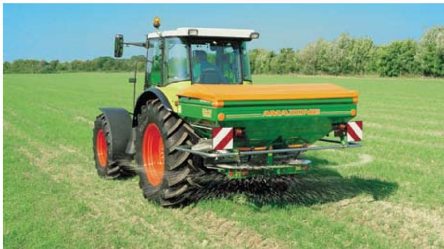
Функционирование разбрасывателя основано на вращении двух дисков, равномерно разбрасывающих гранулы удобрений и семена по полю
