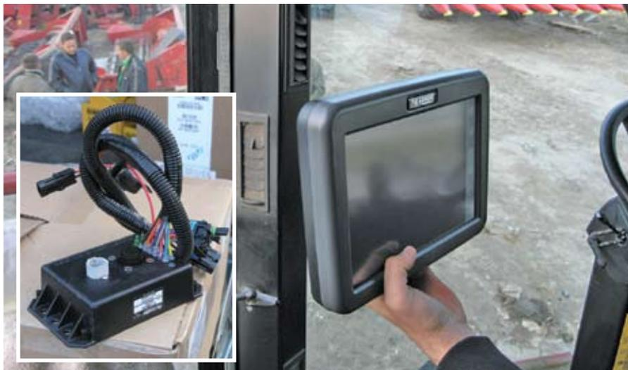
Рис. 3. Контроллер системы (слева), справа – установка монитора в кабине комбайна «Кейс»
