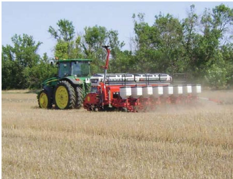
Прямой посев кукурузы в стерню озимой пшеницы с использованием сеялки «Семеато»
