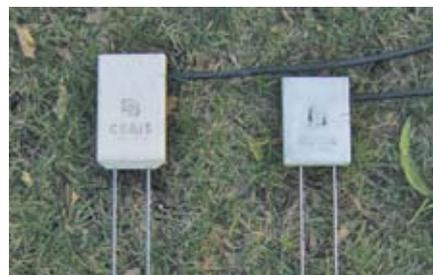
образцах почвы, с использованием датчика влажности почвы Campbell Scientific (тип CS616). Точность показаний была изучена с точки зрения различий в содержании микро- и макроэлементов почвы, а также насыпной плотности. Чтобы показания датчика были точными, требуются достоверные сведения о насыпной плотности почвы.
